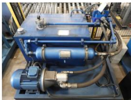
Referencia: DLX-244 CENTRALITA HIDRÁULICA Año: 2004 Marca: RAMPOWER
