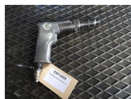
Referencia: EXP-020 ATORNILLADOR PISTOLA NEUMÁTICO Año: . Marca: .
