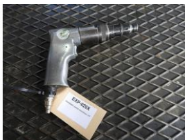
Referencia: EXP-020 ATORNILLADOR PISTOLA NEUMÁTICO Año: . Marca: .
