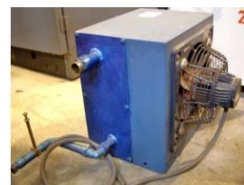
Referencia: BUS-006 REFRIGERADOR AIRE-AGUA Año: . Marca: AIRSEC
