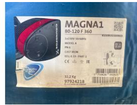
Referencia: LFR-098 BOMBA IMPULSORA Año: . Marca: GRUNDFOS
