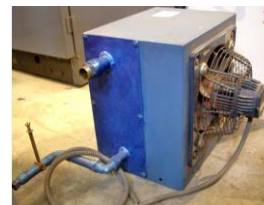
Referencia: BUS-006 REFRIGERADOR AIRE-AGUA Año: . Marca: AIRSEC
