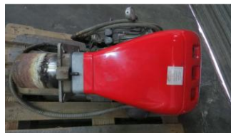
Referencia: DIV-003 QUEMADOR GASOIL Año: 1996 Marca: ROCA
