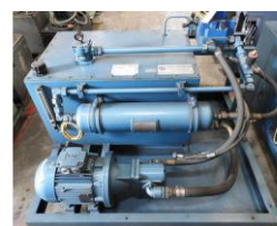
Referencia: DLX-242 CENTRALITA HIDRÁULICA Año: 2004 Marca: RAMPOWER
