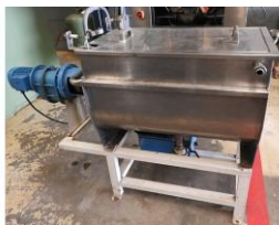
Referencia: NCC-122 MEZCLADORA HORIZONTAL Año: 1973 Marca: IPIASA
