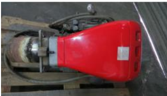
Referencia: DIV-003 QUEMADOR GASOIL Año: 1996 Marca: ROCA
