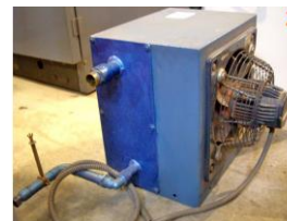
Referencia: BUS-006 REFRIGERADOR AIRE-AGUA Año: . Marca: AIRSEC
